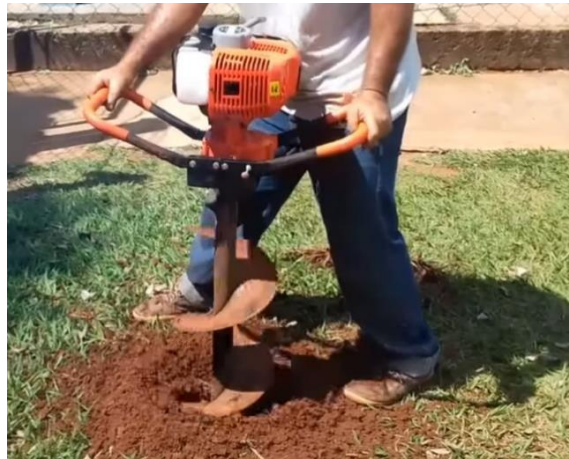
Figura 3 – Trado mecânico a combustível
